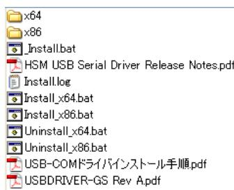
2. ご使用になる OS に合わせたバッチファイル Uninstall\_x64.bat 又は Uninstall\_x86.bat をダブルクリックしてドライバのアンインストールを行います。Windows Vista/7 の場合は、必ず Administrator(管理者) 権限でクリックして、インストールを行ってください。
